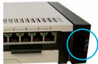
Afbeelding 7: Onderzijde van het breedbandmodem met de poort voor het aansluiten van de telefoons
